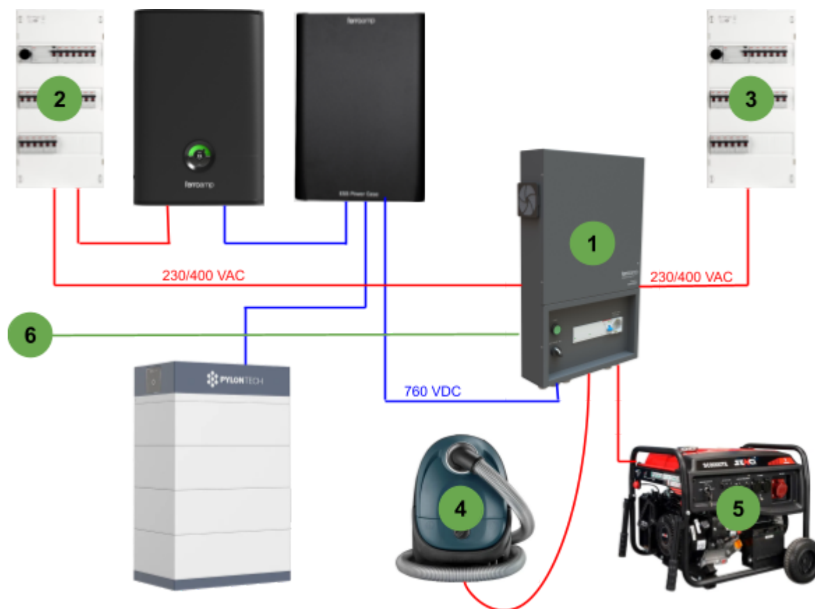
Figur 1 - Översikt av installation med temporär last och elverk
